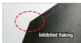
Меньше износ и растрескивание на поверхности переднего угла
